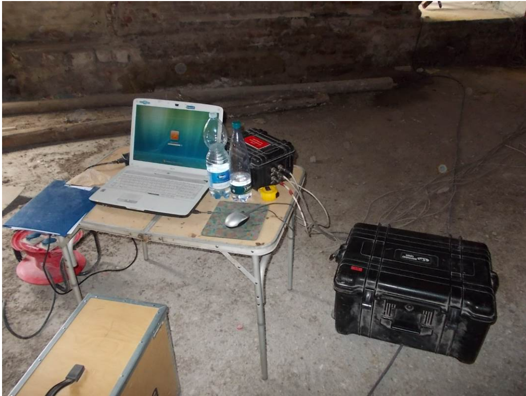
Centralina acquisizione dati e postazione PC.
