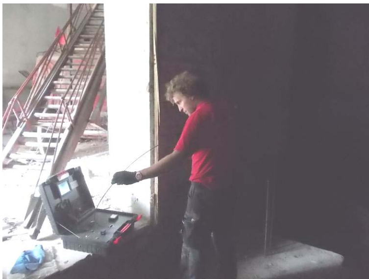
Una fase dei rilievi endoscopici con telecamera a spinta riTEC.
