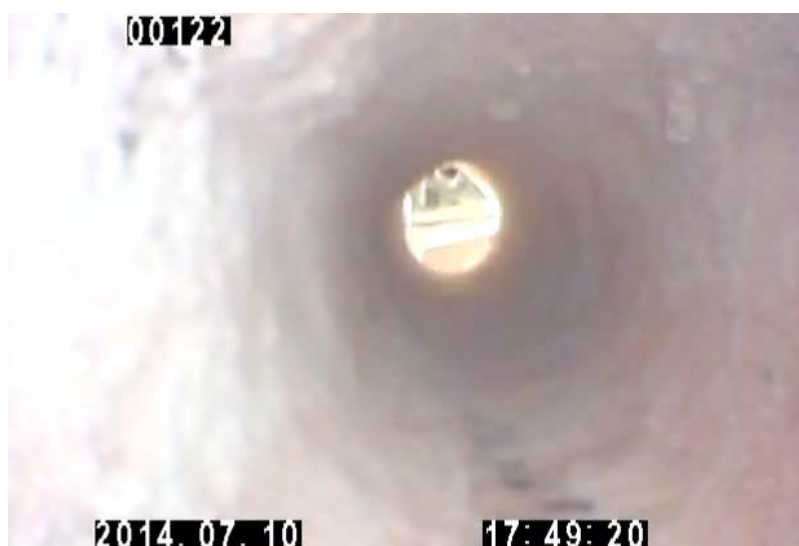
Esempio di videoendoscopia su mattoni pieni.
